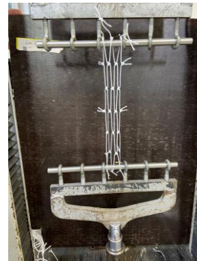
Foto 03 - Resistência à tração na direção Transversal
